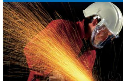
Il sistema di protezione completo offre protezione integrata di vie respiratorie, volto, capo e occhi con un solo dispositivo. Esso è particolarmente utile in presenza di attività lavorative continuative o prolungate.
